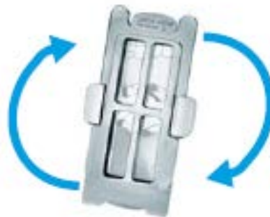
S'assurer de l'étanchéité du système et de la formation d'une bulle mobile
